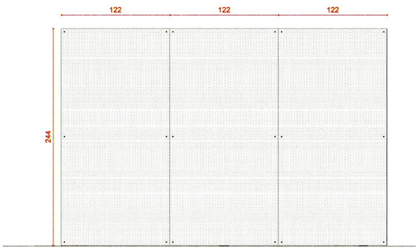
ALZADO A (tablex perforado superpuesto)
